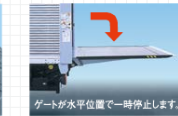
水平停止機能 ゲートが水平位置で一時的に止まります。
